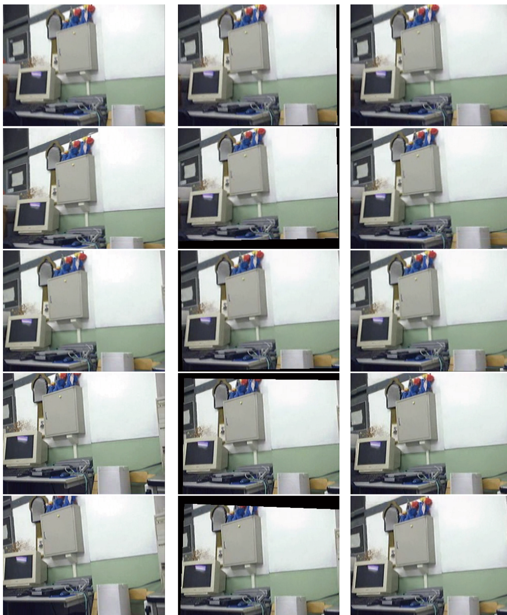
図 12 安定化結果．左の列が補正前のフレーム，中央の列が補正後のフレーム，右の列が補正後のフレームにモザイクングを行ったフレーム．
